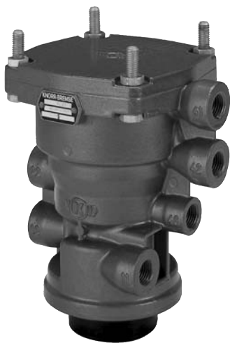
Рис. 15. В клапане управления тормозами прицепа Knorr новой генерации (AC597). В качестве интегрированных узлов содержит глушитель шума. Внутри механизма помещается клапан отрыва, ранее «приклеенный» к клапану в качестве «рюкзака».
