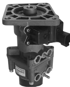
Рис. 5. Педальный клапан, оборудованный датчиком непрерывного действия.
