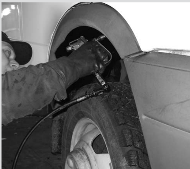
Мастер DINITROL-ЦЕНТРА обрабатывает колесные арки препаратом на битумно-восковой основе.
