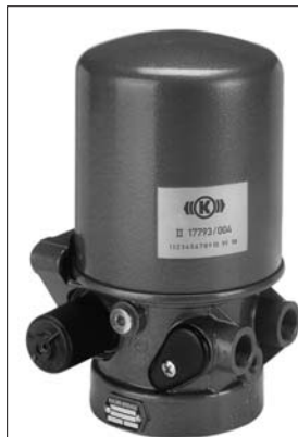
Рис. 4.осушитель воздуха LA 82: принципиальная конструкция соответствует DR 35, в фазе разгрузки через дроссель из ресивера подается регенерационный воздух.
