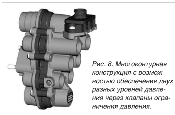
Рис. 7. Многоконтурные защитные клапаны.
