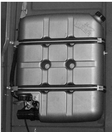
Бак для воды Ebercool, установленный на задней стенке кабины тягача. Раз в сезон нужно залить в него антибактериальное средство, а зимой не забыть слить воду. Вот и весь сервис.
