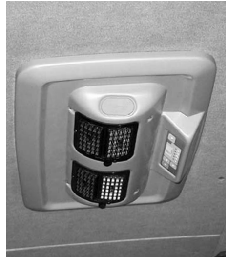
На случай, если снаружи станет слишком холодно, дефлектор оборудован жалюзи, полностью прерывающими любой контакт с внешним воздухом.
