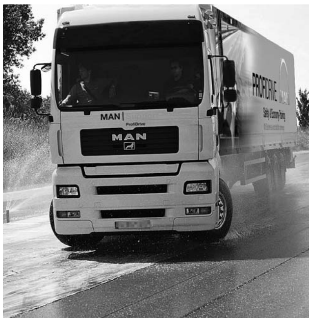
Испытание системы EBS.
