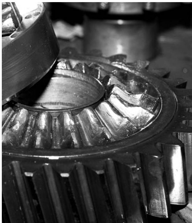
Из-за ошибки водителя может легко «полететь» редуктор ведущего моста.
