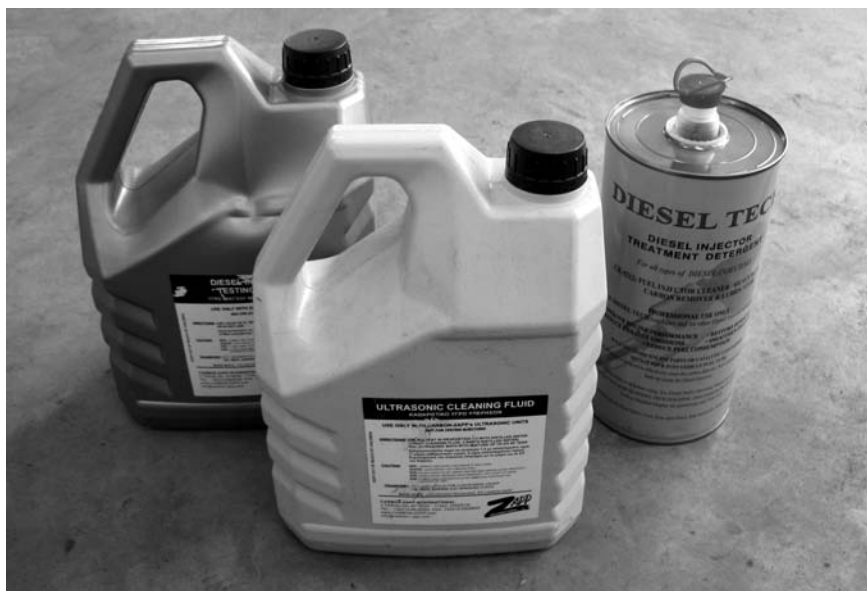
Для функционирования STU-1100e необходимо три жидкости: промывочная, тестовая и для ультразвуковой ванны.
