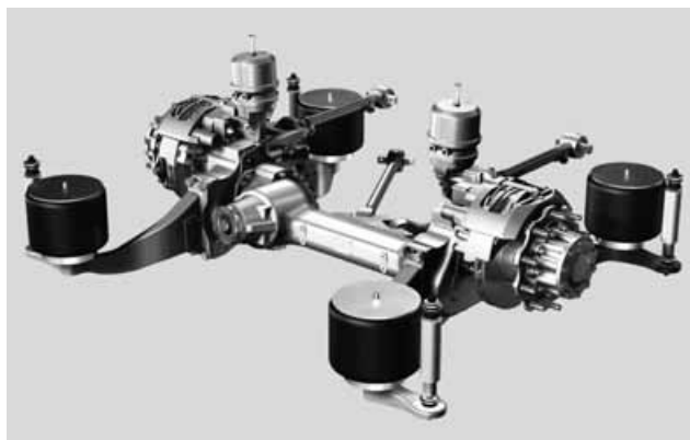
Более быстрый вход и выход: П-образная ось AV 132 фирмы ZF делает возможной сплошную низкую полость во всем автобусе с высотой пола всего 405 миллиметров.
