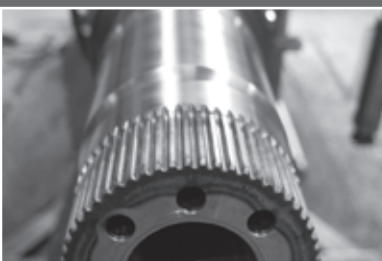
Ось заднего моста готова к дальнейшей обработке
