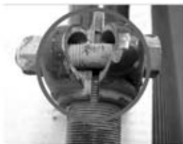
К пункту 3: Болт погнут, зажим не плотный
