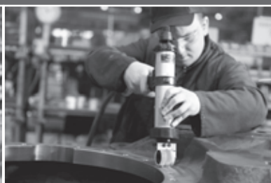
Герметизация фланцевого соединения дифференциала заднего моста с помощью Loctite® 518
