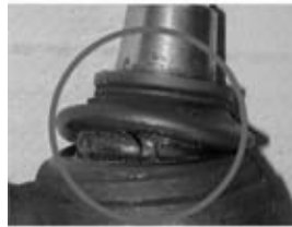
К пункту 2: Трещина в уплотнительном силифоне, выход смазки
