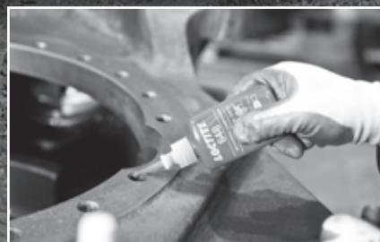
22 болта зафиксированы с помощью Loctite® 648
