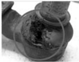
К пункту 2: Уплотнительный силифон полностью поврежден
