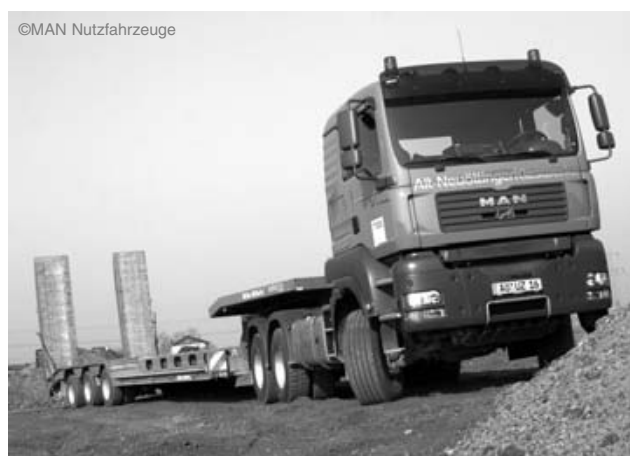
Низкорамный полуприцеп для перевозки спецтехники и негабаритных грузов.
