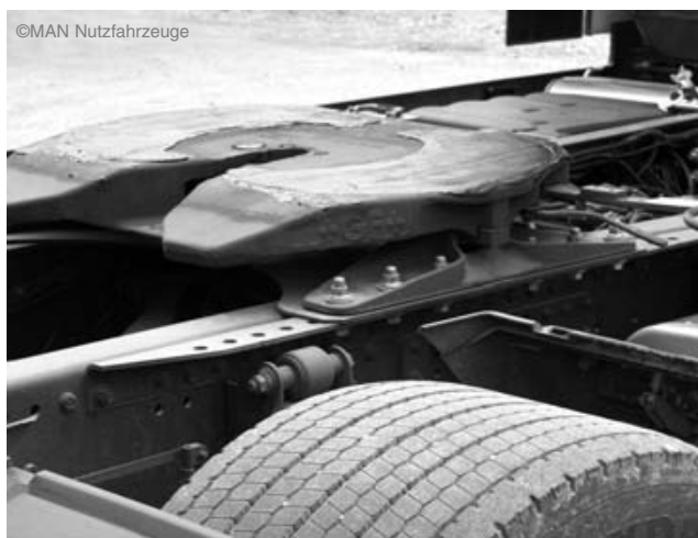
Полуприцеп опирается и закрепляется с помощью седельно-сцепного устройства.
