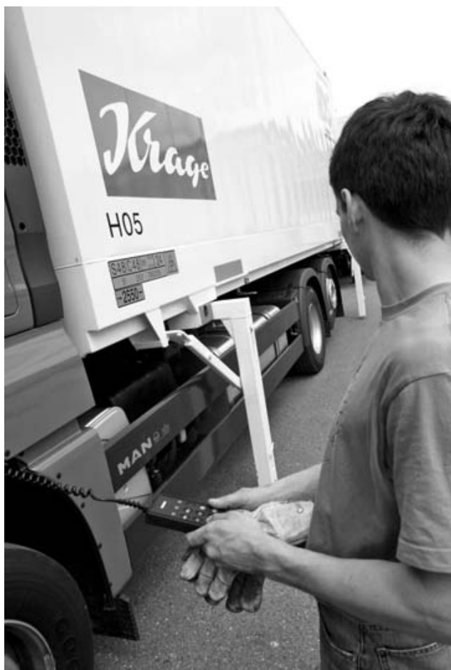
Дистанционный пульт позволяет очень удобно управлять подвеской в ручном режиме (например, при погрузке/разгрузке у рампы).
