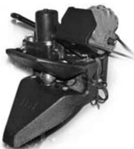
ТСУ шкворневого типа с удлиненной нижней частью вилки и пневмоприводом перемещения шкворня.
