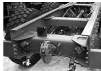
Установка тягового устройства «крюк-петля» на раме грузовика.
