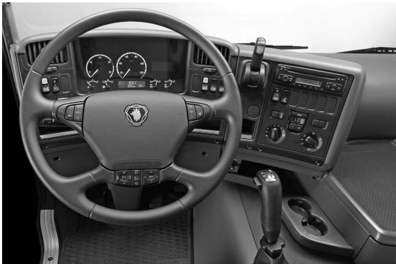
Лучше всего «читаются» круглая и полукруглая разметки бортовых приборов.
