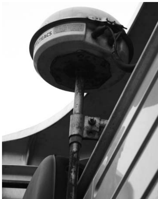
Технически GPS-система состоит из антенны, набора датчиков и сенсоров, позволяющих передавать в диспетчерский пункт информацию о состоянии машины и груза.
