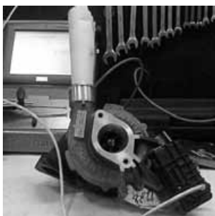
На стенде подключена турбина Garrett GT25 52V с клапаном с электронным управлением (ЭБУ Hella-Garrett) (используется, в том числе, на новых автомобилях Ford Connect 1.8l).
