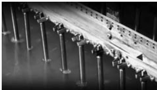
Процесс хромирования штоков на амортизаторах
