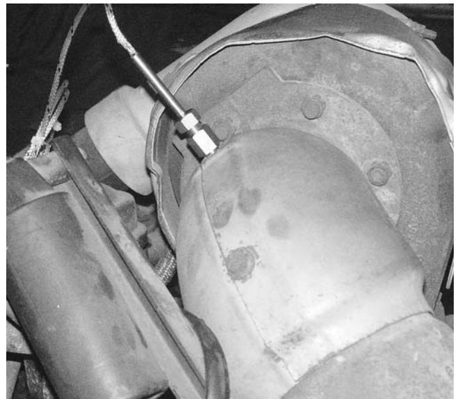
Показания датчика температуры ОГ используются для определения оптимального соотношения дизтопливо/газ.
