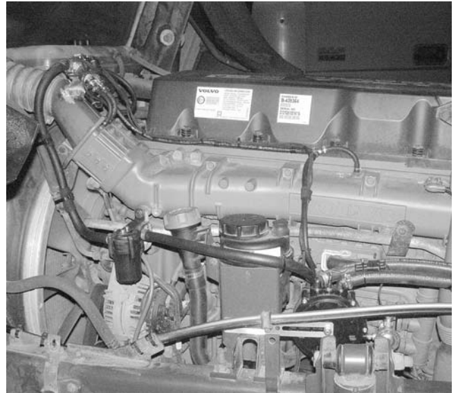
Впрыск газа осуществляется непосредственно во впускной тракт после интеркулера.
