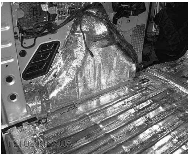
Ultimate Soft металлизированный в качестве барьерного слоя на полу багажника и задних арках автомобиля Peugeot Partner Tepee.
