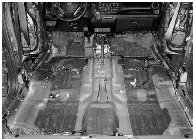
Салон Honda Jazz готов к работам по установке шумоизоляции. Как видно на фото, производителем уже установлен вибропоглотитель.
