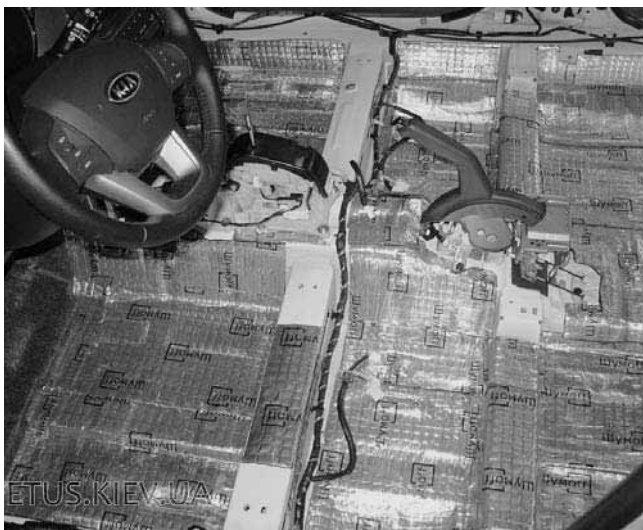
Для локальной работы по вибропоглощению на ребрах и порогах можно использовать Шумофф М3, пример - Kia Rio.
