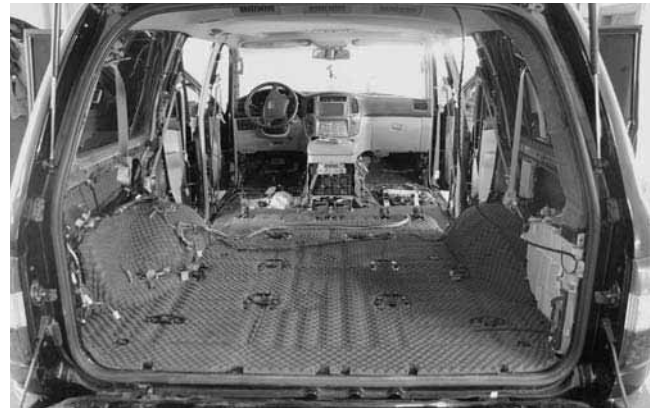
Шумопоглотитель Шумoff Герметон 15 устанавливается для наилучшего результата шумоизоляции.
