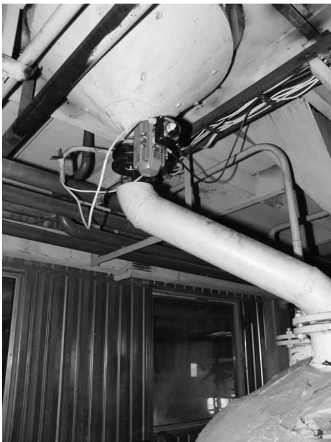
Верхняя часть реактора, дозирующее устройство с выходом в мешалку, трубопроводы для приема и перекачки базовых масел в емкости для хранения.
