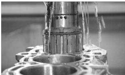
В наши дни точность изготовления деталей ЦПГ обеспечивает зазоры менее 0,02 мм!
