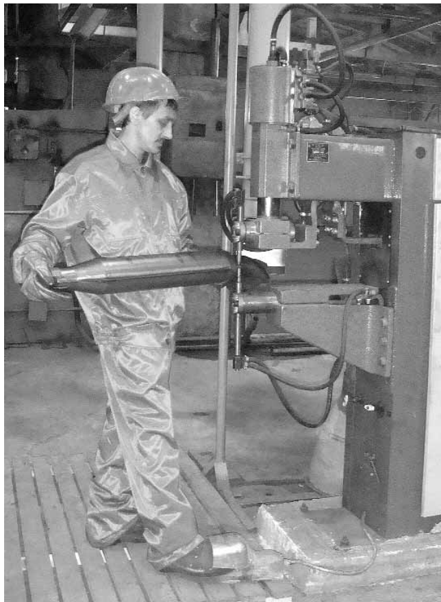
Предприятие изготавливает не только катанные корпуса, но и сварные. Их герметичность обеспечивается надёжной точечной сваркой.
