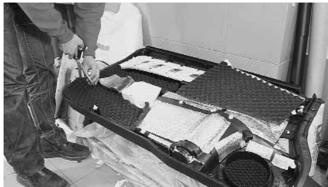
Шумофф Герметон 7 или Герметон 15 комбинируется, учитывая возможность потом собрать дверь.
