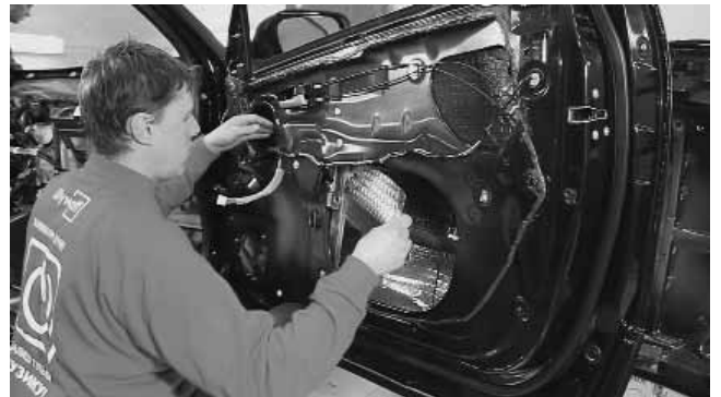
Вибропоглощающие материалы при поклейке через монтажные отверстия все равно придется резать. Поэтому формат листов Шумoff - один из наиболее удобных. На филенку клеится Шумoff M2.
