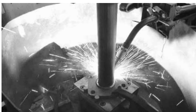
Множество сварочных операций выполняется на специальных сварочных автоматах, что обеспечивает стабильно высокое качество швов, их герметичность и сводит на нет влияние «человеческого фактора». Ручные сварочные работы выполняют опытные высококвалифицированные сварщики.
