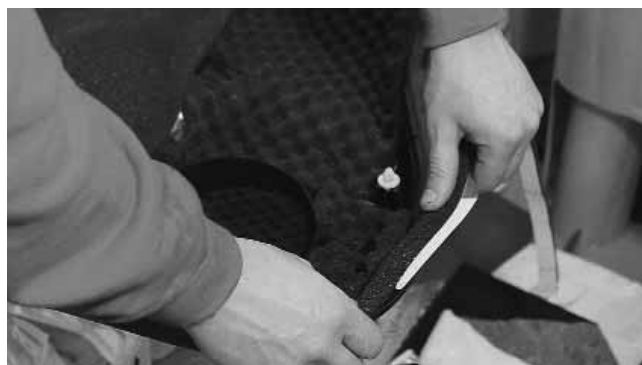
Полоски Шумофф Герметон 7 клеятся по периметру как уплотнитель.
