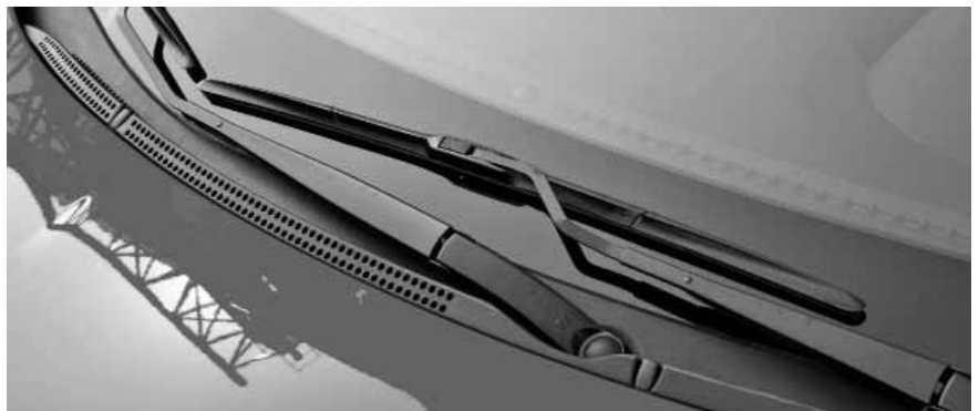
Гибридные щетки от DENSO завоевывают все большую популярность как в серийной комплектации, так и на вторичном рынке. Причиной тому - удачное сочетание преимуществ каркасной и бескаркасной технологий.
