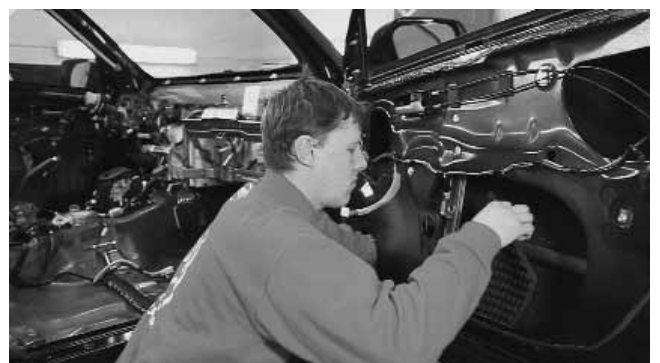
Шумoff Герметон А15 рекомендовано клеить сзади динамика на полторы-две его площади. А при желании - и на всю поверхность филенки. У него также клей водостойкий.
