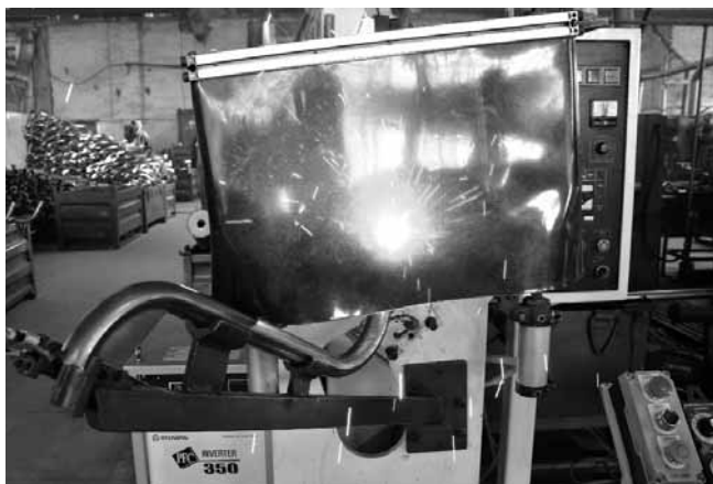
Сварочный автомат для внутренней сварки фланцев с трубами глушителя.
