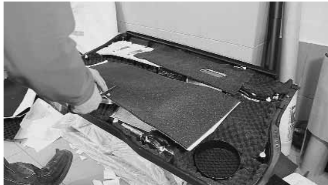
Полоски Шумофф Герметон 7 клеятся по периметру как уплотнитель.
