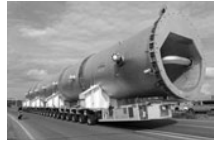
Транспортировка на Ачинский НПЗ (Россия) реактора гидрокрекинга. Вес установки - 1 300 тонн, плюс автотоповоз, который предназначен для его перевозки, - ещё полторы тысячи тонн. Это, в общей сложности, вес хорошей пятиэтажки.
