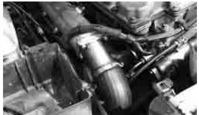
Упразднение клапана EGR - «модернизация» крайне сомнительной ценности.
