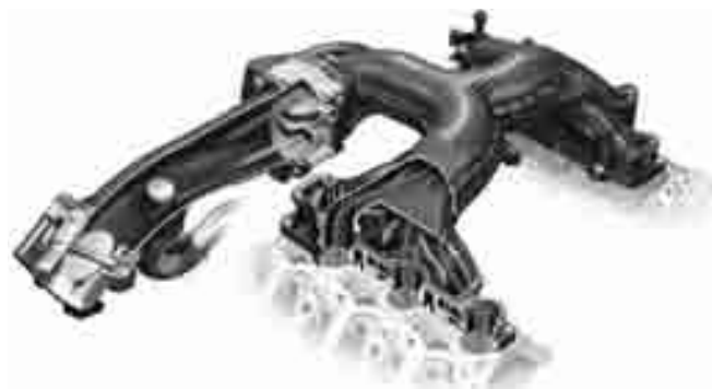
Схема движения воздуха во впускном коллекторе - атмосферный воздух смешивается с горячими газами, поступающими через рециркуляционный клапан EGR.
