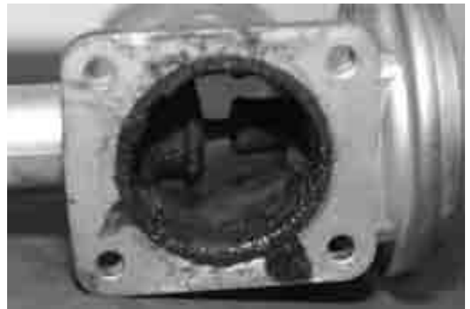
Грязь на клапане системы EGR.
