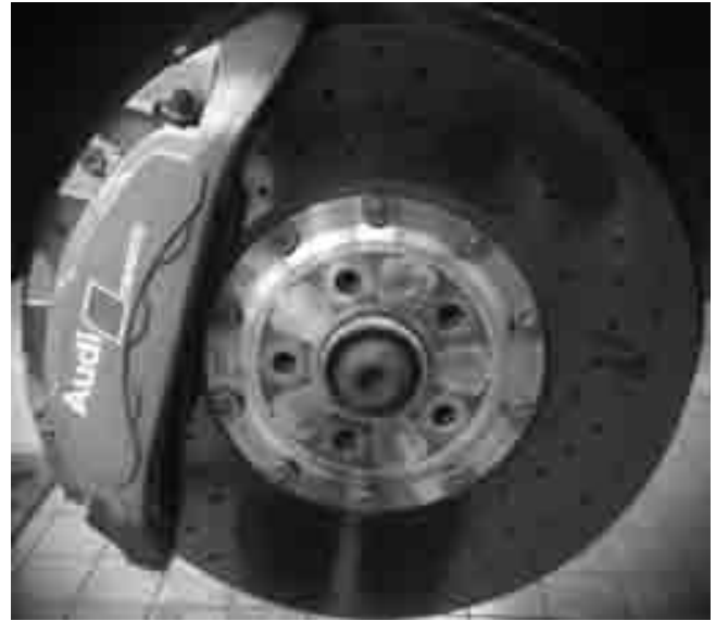
Тормозной диск - основа тормозной системы. Но характер торможения определяется все же тормозной колодкой.
