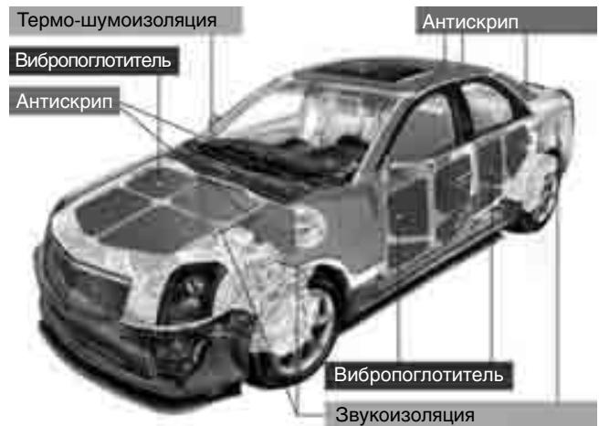
Применение материалов в автомобиле.
