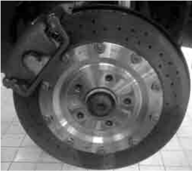
Тормозной диск - основа тормозной системы. Но характер торможения определяется все же тормозной колодкой.
