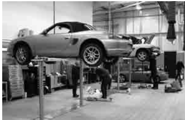
Отсутствие колонн и поперечин: больше пространства для рабочего места, улучшенный доступ к автомобилю, более привлекательный и профессиональный вид СТО.
