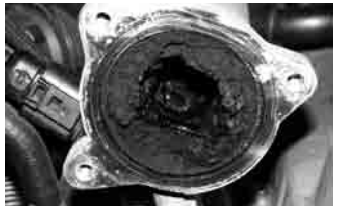
Нагар в мазутоподобном состоянии не оставляет ни одного шанса для возможности работы дизельного мотора.
