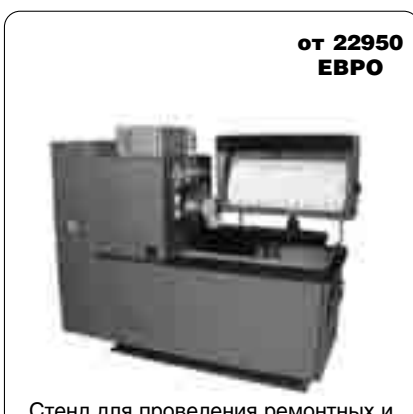
Стенд для проведения ремонтных и регулирующих работ механических ТНВД и ТНВД с электронным управ- лением с количеством секций до 12
