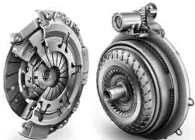
Узел сцепления и маховика в сборе со сцеплением перспективной конструкции системы «start-stop», предназначенной для использования совместно с механической трансмиссией.
