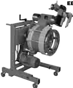
Стенды для проточки тормозных дисков грузовых автомобилей без снятия с автомобиля
