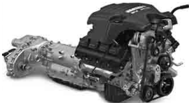
Автоматическая коробка передач (TorqueFlite 8) с 3,6-литровым V6 Pentastar совмещена с системой «start-stop», что позволяет увеличить топливную экономичность и экологичность автомобиля.
