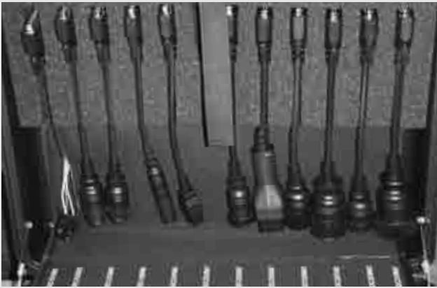
Стандартный комплект переходных кабелей для автомобилей и прицепов.
