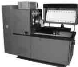
Стенд для проведения ремонтных и регулирующих работ механических ТНВД и ТНВД с электронным управ- лением с количеством секций до 12
