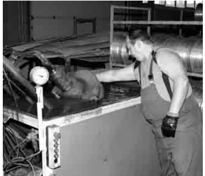
Обязательный контрольный этап - проверка диска на герметичность давлением воздуха в ванне с водой.
