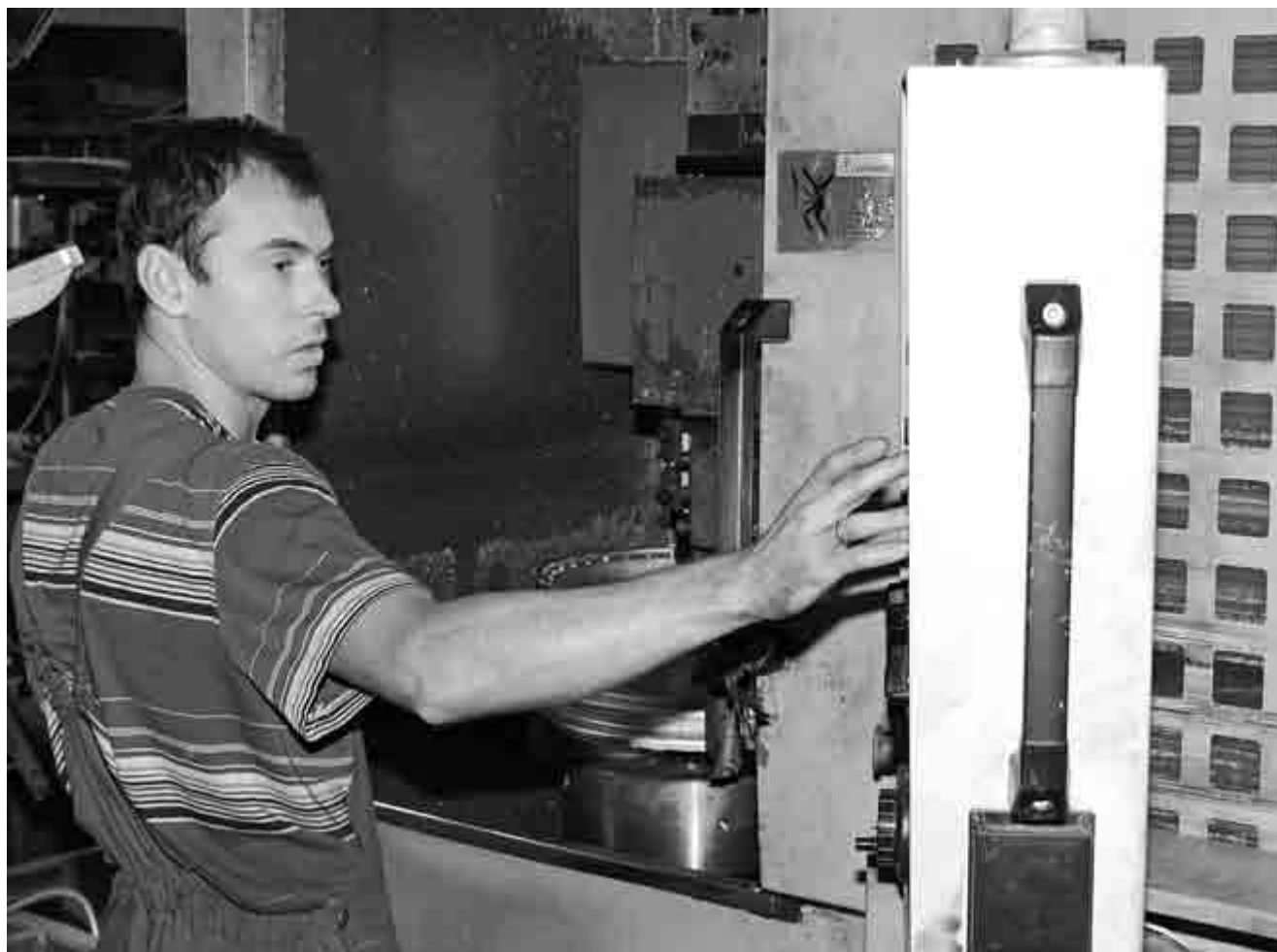
Тщательно и скрупулезно. Литая заготовка приобретает вид диска после прохождения механической обработки поверхностей и закраин на нескольких современных станках с ЧПУ. Контроль качества - на каждом этапе.
