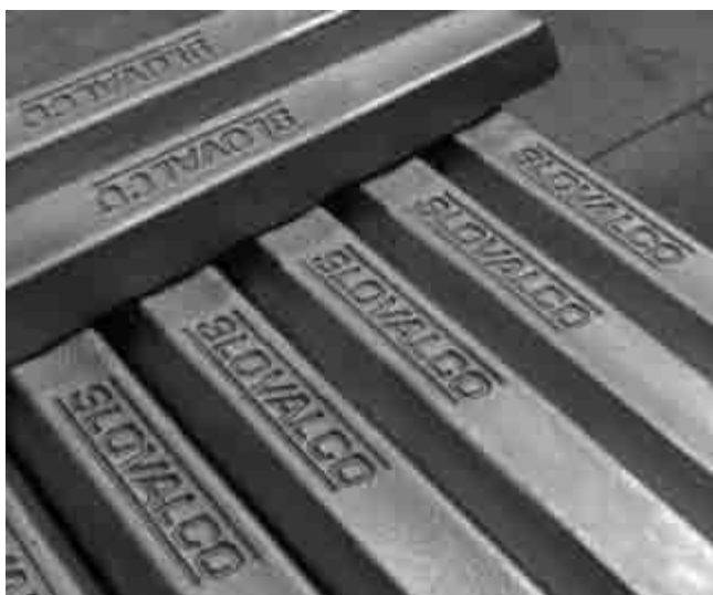
Производственный процесс начинается с плавки чушек алюминия, поставляемых известным производителем Hydro.
