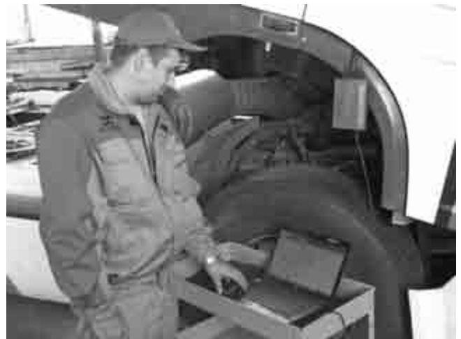
Мультимарочный сканер Bosch KTS Truck «Дальнейшей сервис» приобрел одним из первых в Украине. Теперь он незаменимый помощник в работе, так как «читает» электронные системы управления почти всех автомобилей, автобусов и прицепов.
