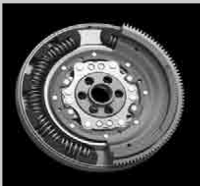
Двухмассовый маховик ZMS-TD с непосредственным отбором мощности. Применяется для двухдискового сцепления, гибридного привода, а также вариаторов.
