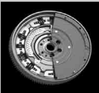
Двухмассовый маховик для больших и средних двигателей до 350 Нм. Встроенная поверхность трения пропорционально увеличивает сопротивление при увеличении угла поворота вторичной массы относительно первичной массы.
