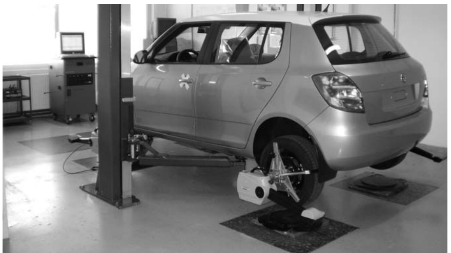
Для проверки правильности установки развала-схождения лаборатория, как и производство, использует стенд Beissbarth. Но здесь не требуется регулировка, поэтому достаточно двухстоечного подъемника и выставленных по уровню гранитных плит под колесами.
