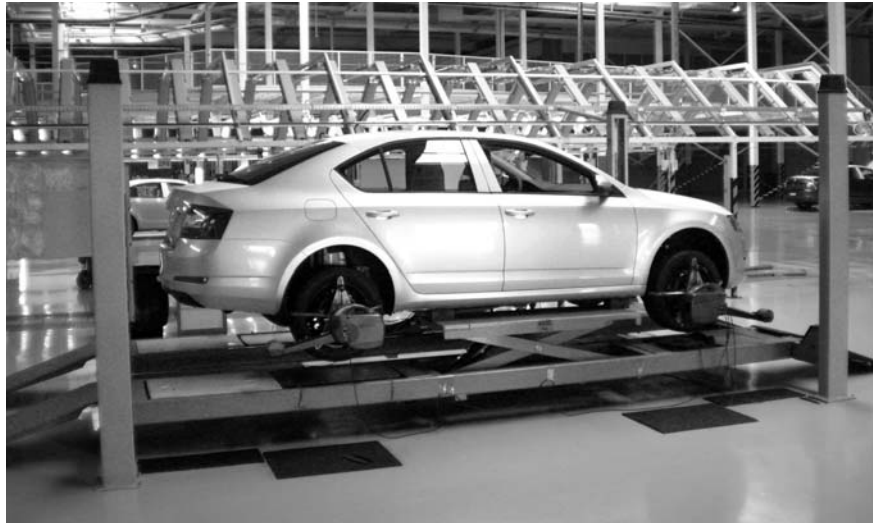
На сборочной линии используются четырехстоечные подъемники со стендом развала-схождения Beissbarth, способного выдержать производственные нагрузки, исчисляющиеся несколькими десятками автомобилей в день.
