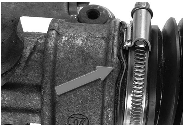
Пыльник рулевой рейки смонтирован неправильно.
