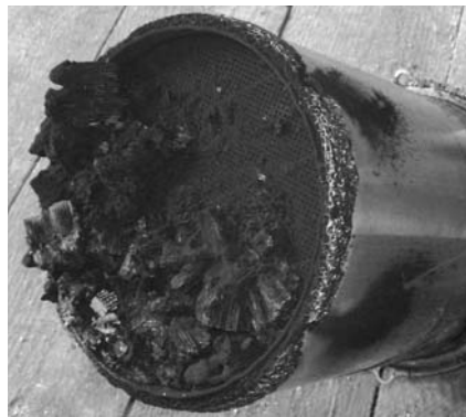
При исправности всех других систем, если сажевый фильтр переполнен сверх нормы, принудительный запуск регенерации может не удалиться.
