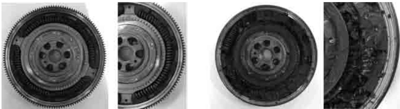
Неисправности ДММ часто незаметны внешне, поэтому обнаруживаются лишь после вскрытия. Для этого и нужно четкое определение диагностики. На фото: слева исправный маховик ZMS, справа - подверженный перегрузками.
