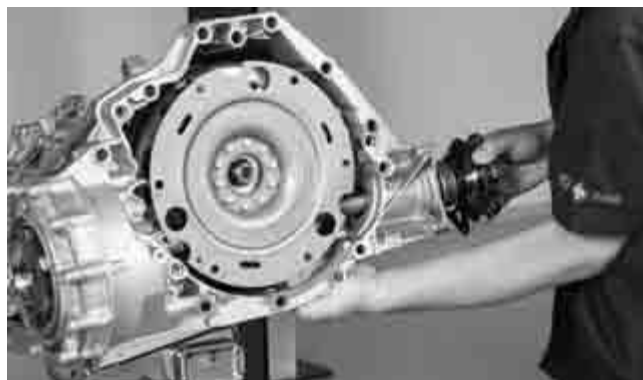
Во избежание повреждения радиального уплотнения ведущего вала со стороны коробки передач, при установке вал должен поддерживаться свободными пальцами руки сквозь нижнее техническое окно в корпусе коробки передач. Только таким образом вал привода может быть отцентрирован при его установке в посадочное отверстие.
