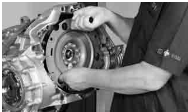
Только после того, как применён специальный регулировочный инструмент, модуль сцепления устанавливается на коробку передач.
