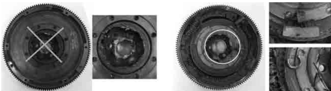
Характерные следы перегрева на ДММ - "побежалости". Трещины на рабочей поверхности показатель замены ДММ.
