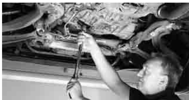
Установка коробки передач: все болты должны быть затянуты с моментом затяжки в 60 Нм
