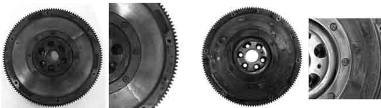
Характерные следы перегрева на ДММ - "побежалости". Трещины на рабочей поверхности показатель замены ДММ.
