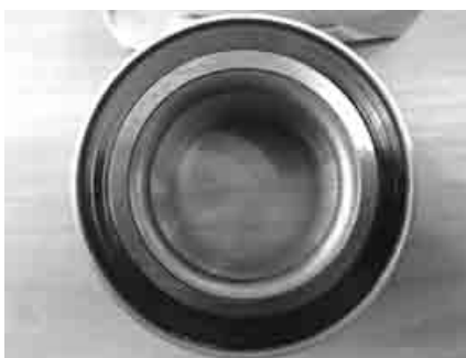
На оригинальном подшипнике выбит производитель KBC. На «копии» оригинала указан неизвестный DAD.
