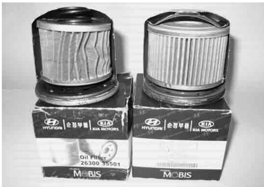
Даже при абсолютном внешнем сходстве оригинальный масляный фильтр всегда отличается качеством бумаги и клапаном.
