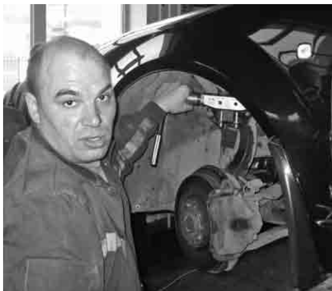
Применение специнструмента при работе с закипевшими болтами в ходовой.
