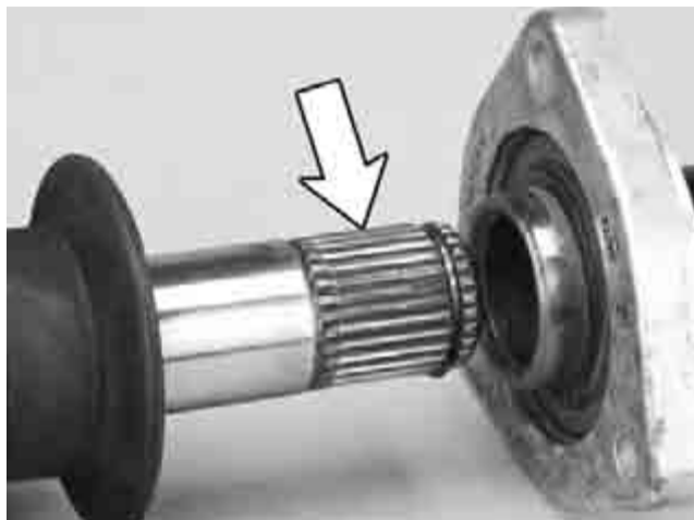
Фото 1. Место нанесения смазки в месте соединения приводного вала.
