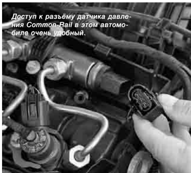
Подключение к датчику давления наддува тоже не составляет проблем.
