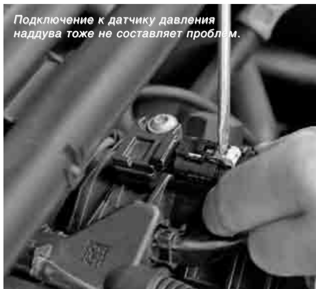
Разъёмы кабелей автомобиля соответствуют разъёмам автомобиля - нужно просто вставить, зафиксировать и готово!
