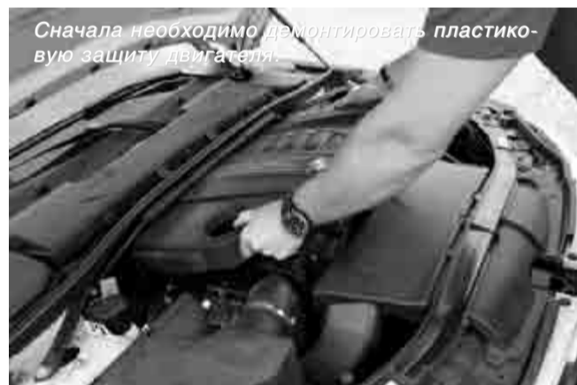
Под пластиковой крышкой находится шумоизоляция - её тоже необходимо аккуратно снять.
