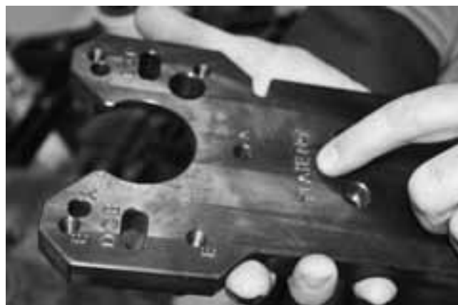
К стапелю полагается иметь комплект вот таких маркированных плит-адаптеров для разных моделей насосов. Плиты идентифицируются по маркированию
