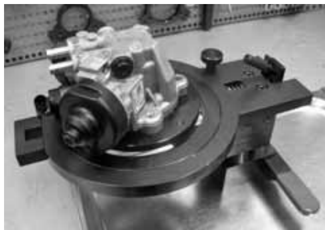
На стапеле Шамровского даже такая новинка, как топливный насос BOSCH CP4.2, надежно закрепляется и выставляется в любое положение, предусмотренное технологией ремонта
