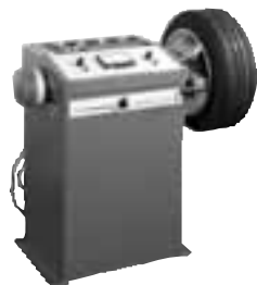
В 1961 году компания Hofmann производит балансировочный стенд ER2, который производился до 1978 года. Даже в наши дни в мастерских можно встретить этот стенд в полностью рабочем состоянии.
