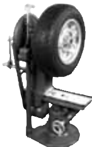
В 1949 г. Hofmann разработал первый механический балансировочный стенд для авторемонтных мастерских.
