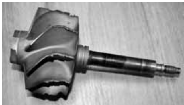
Турбінне колесо із слідами оплавлення через надмірно збагачену паливну суміш
