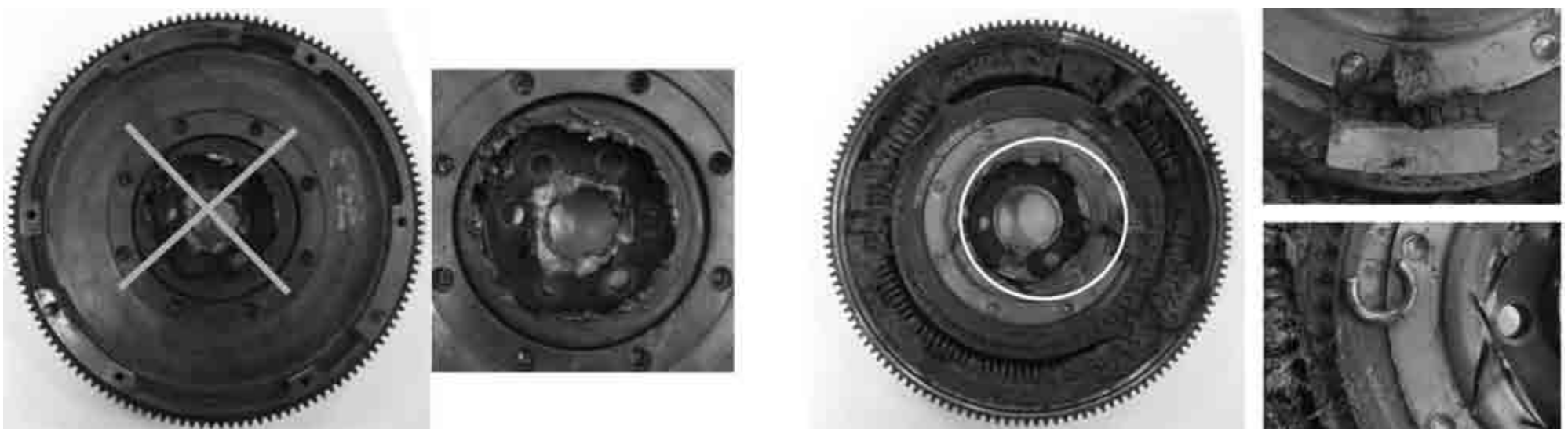
Трещины на рабочей поверхности показатель замены ДММ.
