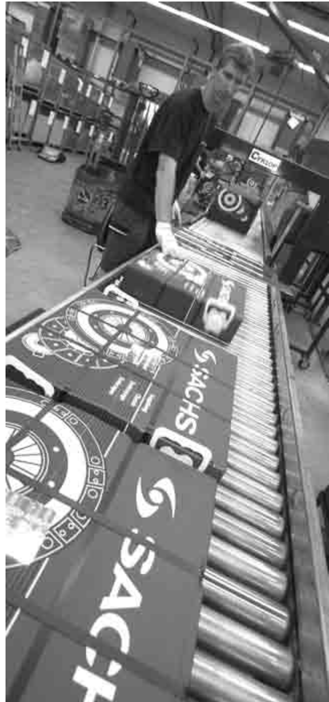
Маховики поставляемые в первичную комплектацию и упакованные в синие коробки Sachs сходят с одной и той же линии конвейера.
