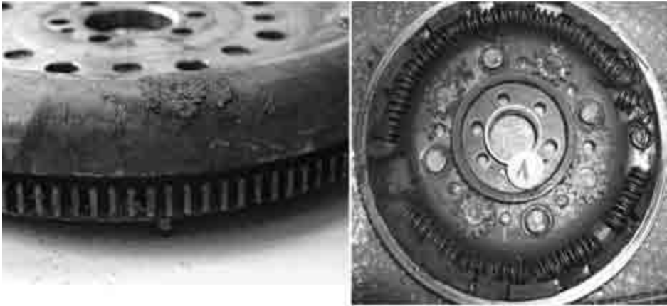
Выступающая смазка говорит о повреждении корпуса. Это ведет к повреждениям внутри механизма.
