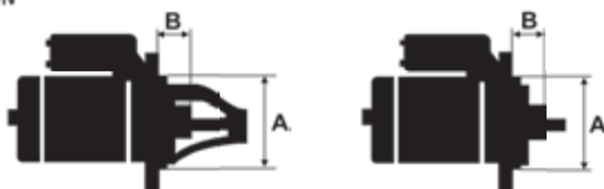
Установочные параметры стартера: А - диаметр посадочного фланца, В - вылет обгонной муфты (бендикса)
