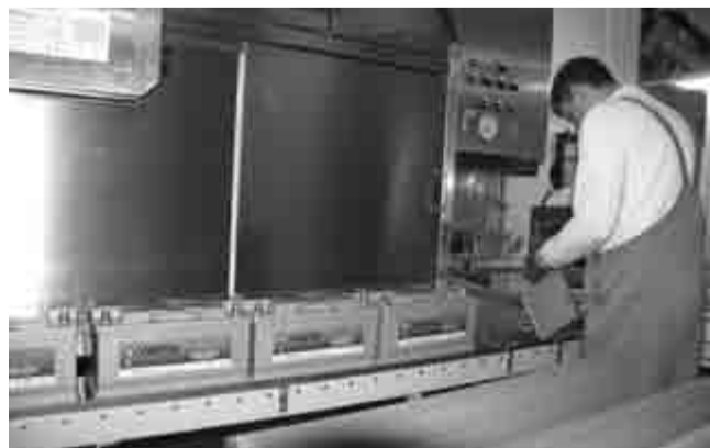
Финальный этап - проверка AGM-аккумуляторов.
