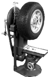
В 1949 г. Hofmann разработал первый механический балансировочный стэнд для авторемонтных мастерских.
