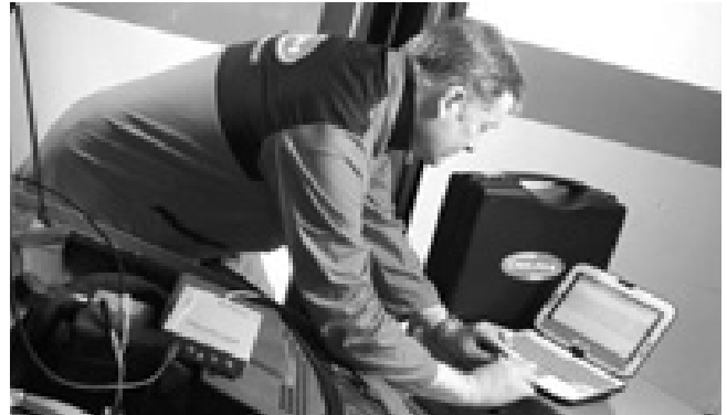
Механик тестирует наличие сигнала на пути от датчика коленвала к ECU с помощью переходника breakout box Delphi и прибора PicoScore.
