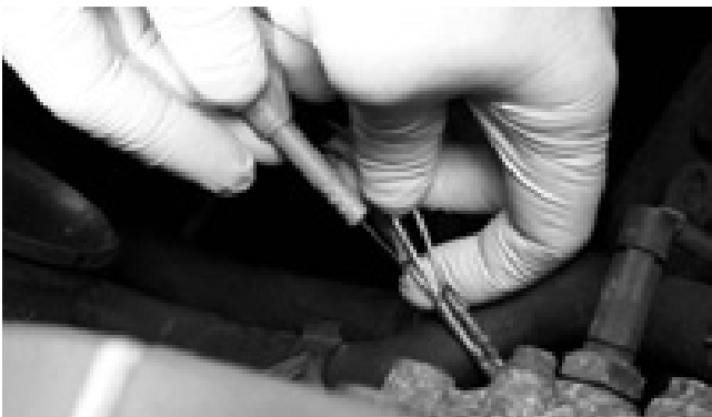
Механик вводит зонд PicoScore в 2-штырьковый тестовый переходник mini-bob (уже подсоединенный к разъему датчика).
