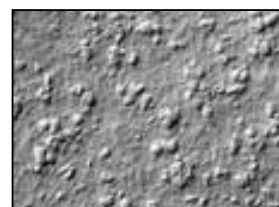
Фото 10. Окончательно обработанная ALUSIL рабочая поверхность цилиндра (механическое шлифование после раскрытия). Снято тонкой прозрачной пленкой Faxfilm для прямой съемки структур поверхностей.
