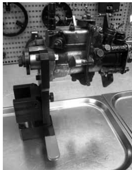
ТНВД VP44, VE и DPS типа на Стапеле, который позволяет без проблем закрепить и ремонтировать большинство современных дизельных насосов
