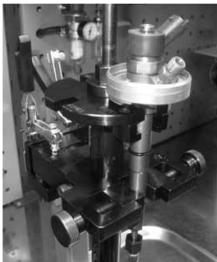
CR инжектор BOSCH, CR насос CP1S и CR насос CP1K на Стателе (разработка «ДиМеД»)
