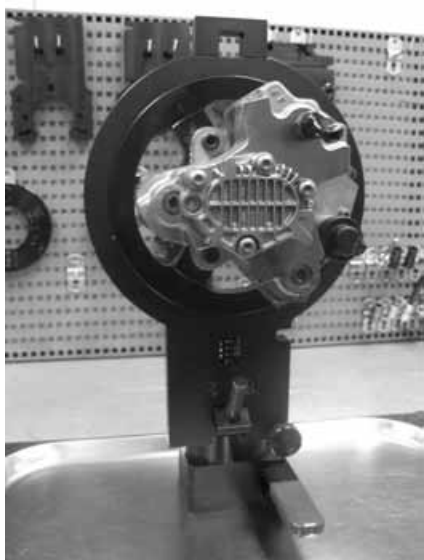
Главный плюс «димедовского» стapeля - универсальность. (На фото - насосы CP3.3, DFP1, HP0 на стapeле)
