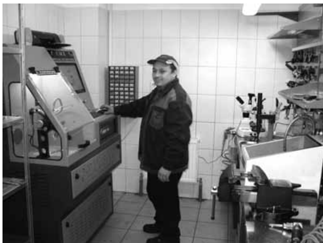
Созданное на основе собственных разработок и импортного оборудования - универсальное рабочее место для мастера по ремонту инжекторов
