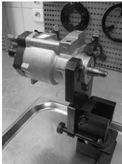
Главный плюс «димедовского» стapeля - универсальность. (На фото - насосы CP3.3, DFP1, HP0 на стapeле)
