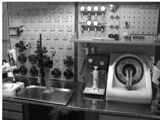
Созданное на основе собственных разработок и импортного оборудования - универсальное рабочее место для мастера по ремонту инжекторов
