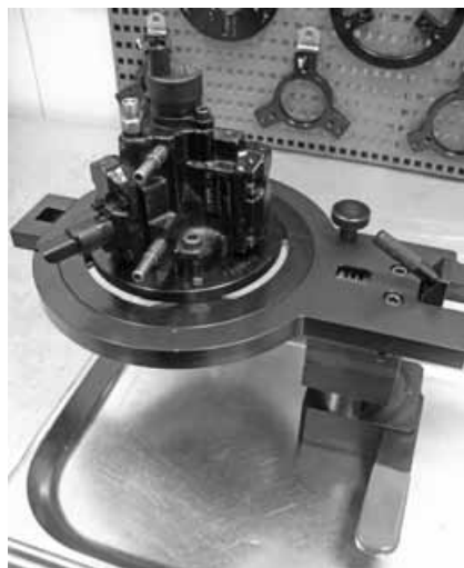
CR инжектор BOSCH, CR насос CP1S и CR насос CP1K на Стателе (разработка «ДиМеД»)
