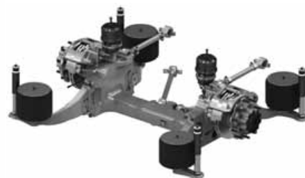
ZF AVN-132: бесприводный мост portalного типа AVN-132 позволяет расположить пол автобуса на высоте от 355 миллиметров.
