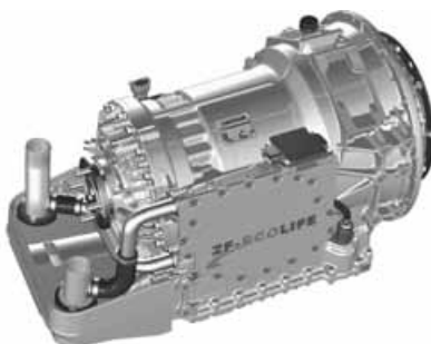
ZF EcoLife: шестиступенчатая автоматическая трансмиссия EcoLife передает больший крутящий момент при значительном снижении потребления топлива.
