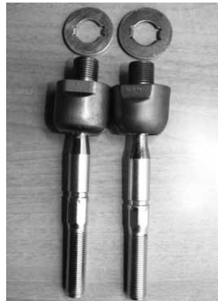
Рулевые тяги: подделка – слева. Сразу же бросается в глаза отсутствие маркировки.
