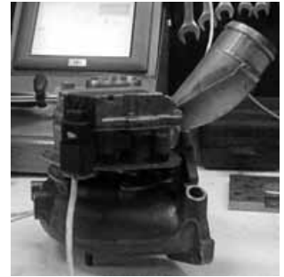
На стенде подключена турбина KKK BV50 с клапаном с электронным управлением (ЭБУ Siemens VDO) (используется на автомобилях Volkswagen T5).
