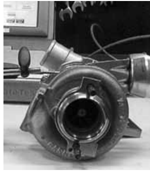
На стенде подключена турбина Garrett GT25 с вакуумным клапаном (используется на некоторых автомобилях BMW).
