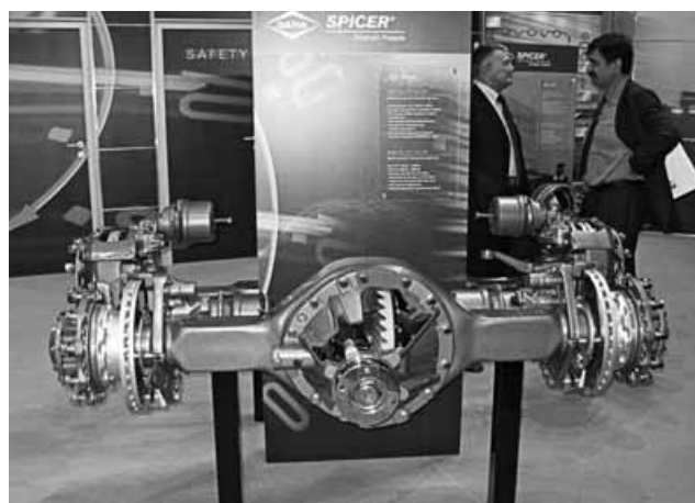
Усовершенствованный мост из серии Dana Spicer G11.170/13.190
