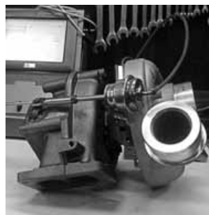
На стенде подключена турбина KKK K31 с клапаном нагнетания (используется на грузовых автомобилях MAN и DAF).
