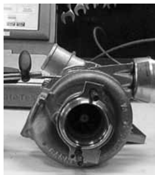
На стенде подключена турбина Garrett GT25 с вакуумным клапаном (используется на некоторых автомобилях BMW).
