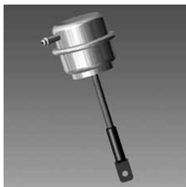
Клапан нагнетания (используется на большинстве «старых» турбин).
