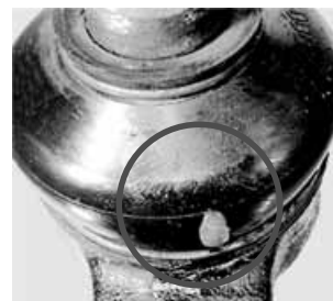
Повреждение уплотнительного сальника на шарнире независимой подвески вследствие использования неправильного инструмента (отвертки)
