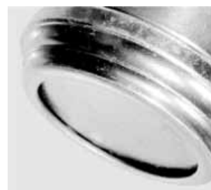
Рисунок для сравнения к приведенному слева повреждению: так выглядит крышка в исправном состоянии
