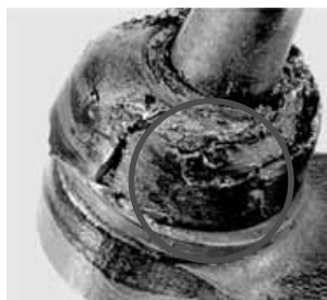
Повреждение уплотнительного сальника шарнира независимой подвески, вызванное контактом с тормозной жидкостью или моторным маслом
