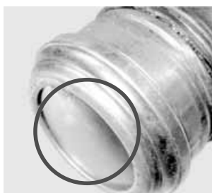
Изгиб крышки, вызванный сильным перенапряжением или вследствие удара молотком по шаровой цапфе
