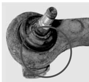
Пример типичного образования ржавчины на детали ходовой части, вызванного водяными брызгами или соли для посыпки улиц
