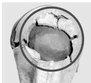
Кратковременное косвенное повреждение поперечного рычага подвески из-за неплотности резинового сальника
