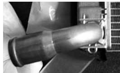
Крепление патрубка радиатора отопителя для автобуса ЛиАЗ
