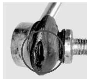
Повреждение уплотнительного сальника на стабилизаторе вследствие удара камнем или касания автомобилем земли
