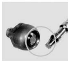
Отрыв осевого шарнира (наезд на бордюрный камень или выбоину)
