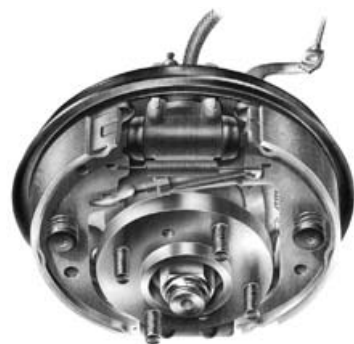
В барабанном тормозе фрикционный материал контактирует с внутренней стороной тормозного барабана.
