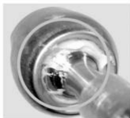
Выход из строя пластичной смазки осевого шарнира вследствие перегрева
