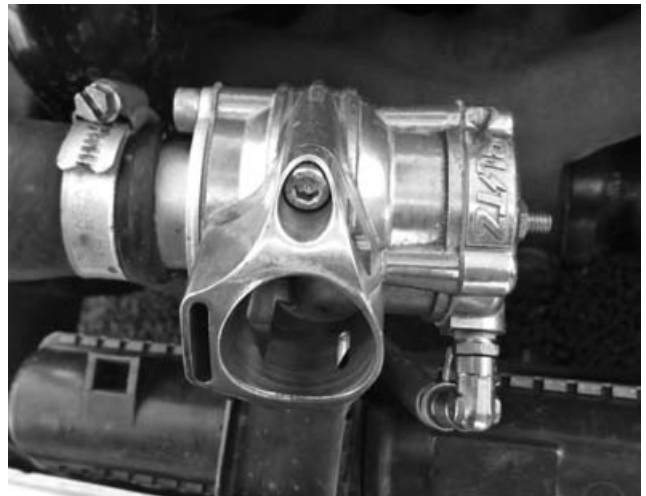
Клапан блоу-оффа ослабляет давление воздуха в тот момент, когда дроссельная заслонка закрывается и защищает компрессор от резкого скачка давления.
