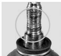
Повреждение резьбы осевого шарнира и наконечника рулевой тяги, вызванное навинчиванием гайки с неправильным шагом резьбы
