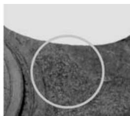
Ржавчина, вызванная водяными брызгами или соли для посыпки улиц
