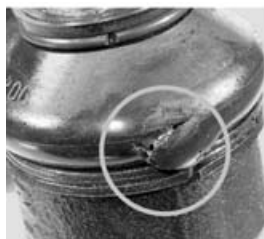
Повреждение вследствие использования отвертки
