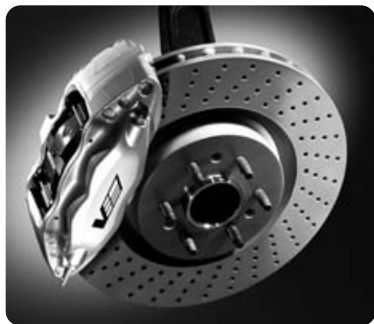
Дисковые тормоза более эффективны и лучше охлаждаются, но сильно подвержены загрязнениям.
