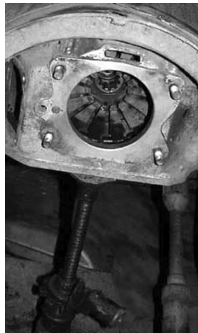
КПП снята. Внизу домкрат, выполняющий роль снятой опоры.
