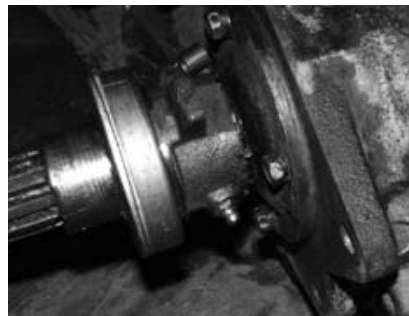
Снятие корзины сцепления. Слева – монтировка, упирающаяся в венец маховика.
