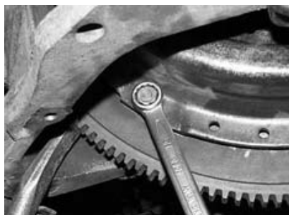
Снятие корзины сцепления. Слева – монтировка, упирающаяся в венец маховика.
