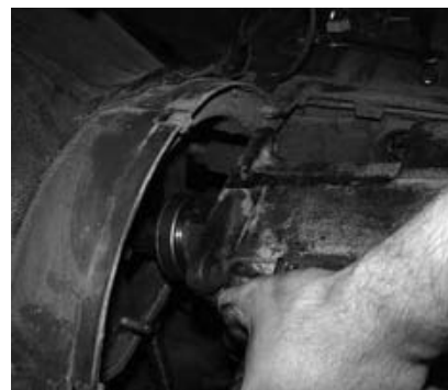
Аккуратно, чтобы не забить резьбу шпилек, КПП была снята.
