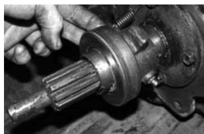
Выжимной подшипник и его муфта. По резьбе в муфте вкручена обычная пресс-масленка.
