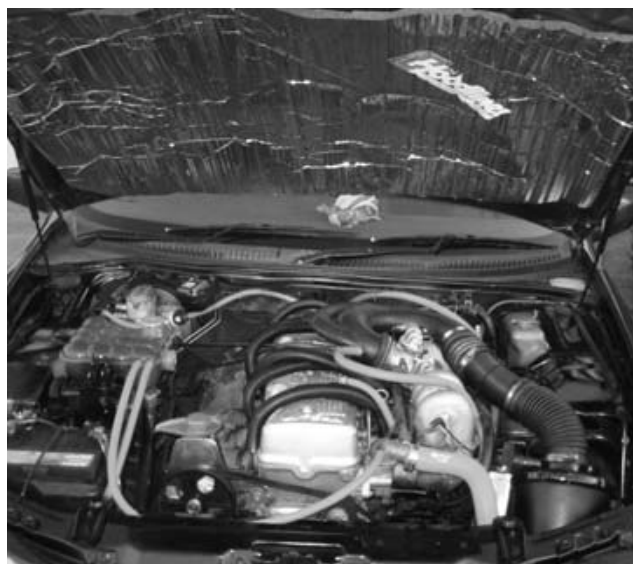
Для ослабления шума двигателя, желательно его поглощение пористыми звукопоглощающими панелями.
