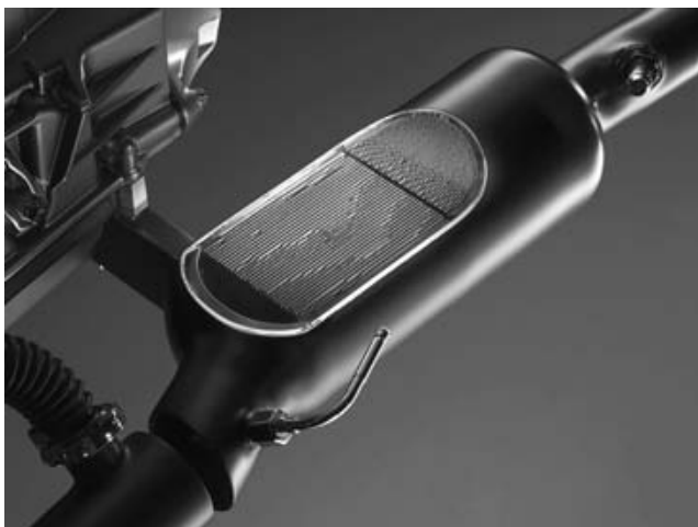
Катализатор выполняет роль дополнительного глушителя.
