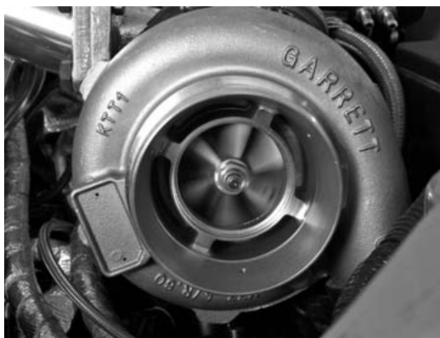
Турбокомпрессор может быть причиной повышенного расхода масла в случае износа подшипников и забитой линии отвода масла.
