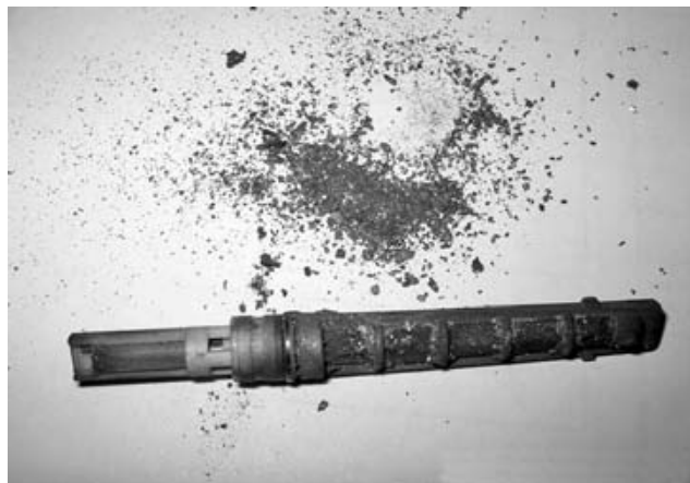
С компрессионных колец в систему спиливается графит (компрессионные кольца сделаны из графита), забивая ресивер-осушитель и ТРВ продуктами износа.
