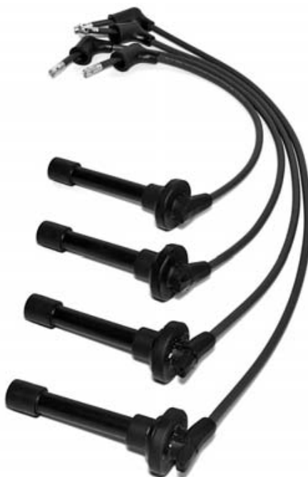
Еще одна проблема, преследующая двигатели Mitsubishi - пробой высоковольтных проводов.
