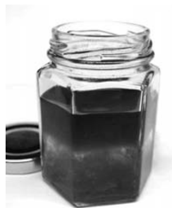
Даже простейший опыт наглядно демонстрирует, насколько хорошо, а главное, с какой поразительной скоростью компрессорное масло реагирует с водой.
