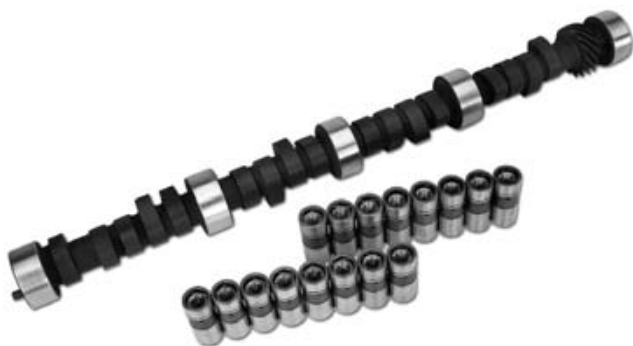
При использовании масла сомнительного качества в первую очередь умрут гидротолкатели.
