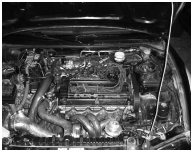
Если при замене ремня ГРМ не поменять ремень балансирующих валов, в результате можно получить гнутые клапаны.
