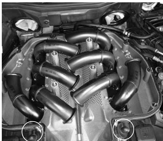
На фото отмечены два входа в маслоотделитель.
