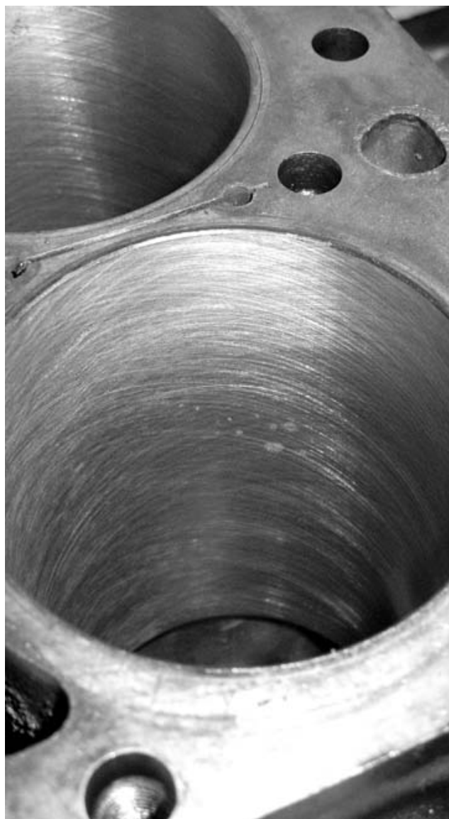
На стенках цилиндра четко видны насечки, сделанные при профессиональном хонинговании, с помощью которых удерживается масло.
