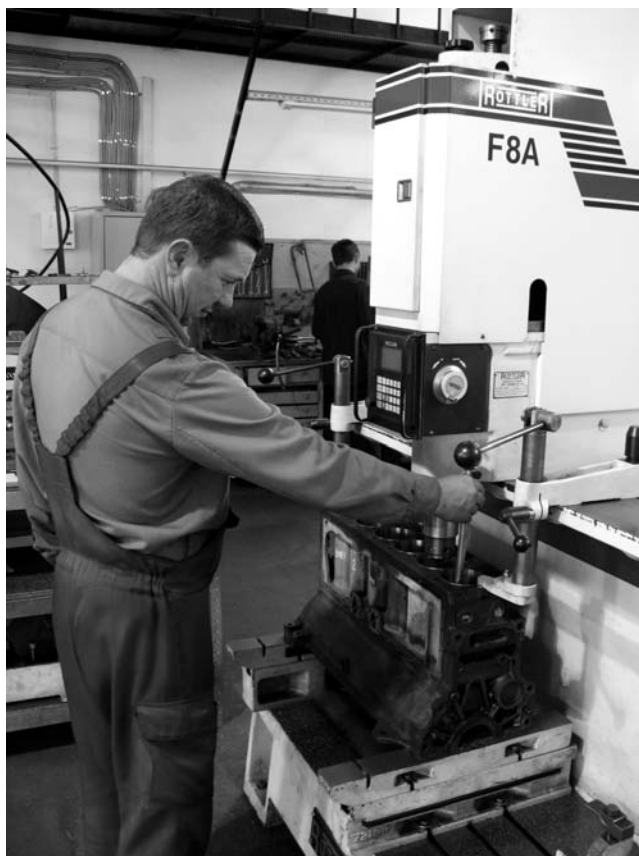
Расточка клапанов быстрее всего производится на профессиональном оборудовании.
