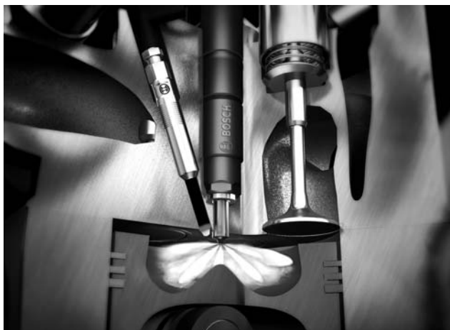
Среднее количество циклов «открытие-закрытие» у форсунки составляет около миллиарда раз.
