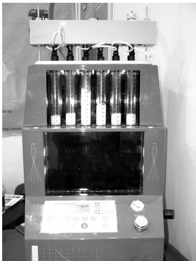
Стенд для промывки форсунок отечественного производства (компания SV Auto).
