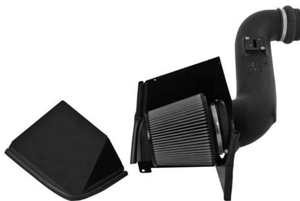
Фото 1. Классика – ФНС K&N. Снижение сопротивления на впуске присутствует, но это же часто конфликтует с расчетными настройками частот резонанса, что приводит не к приросту, а падению отдачи в достаточно широком диапазоне оборотов. В какой-то степени вопрос решается применением удлиненных патрубков и айр-боксов... Но это – не панацея. Потому для не-гоночного использования стоит ограничиться «облегченной версией» – фильтрующим элементом традиционного типа.
