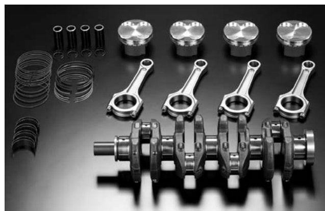
Фото 6. Набор из облегченных поршней, шатунов и коленвала в исполнении Toda Racing – ничего экстраординарного, но крайне полезно для напряженных режимов, т.к. – «только для гонок».
