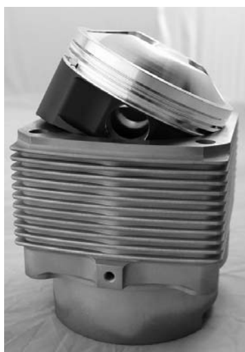
Фото 7. Поршень и цилиндр для форсированных версий «воздушных» Porsche, именно этот набор – для 964 turbo и 993. Кроме хорошей теплопроводности цилиндров и стабильности геометрии поршня, «одним махом» увеличивает объем с 3,6 л до 3,8. Сделано красиво, но уже – история.
