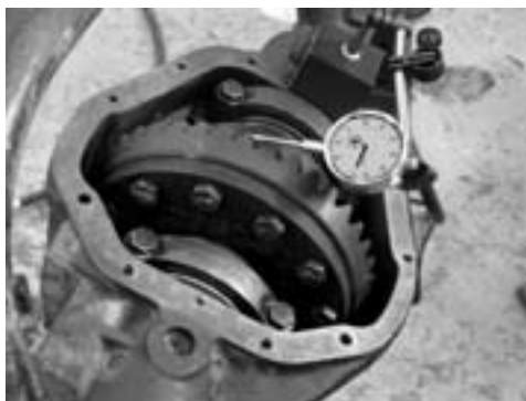
Фото 15. Измерение зазора при помощи циферблатного индикатора.
