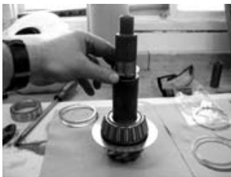
Фото 9. Установка прокладок предварительного натяга шестерни на шестерню.
