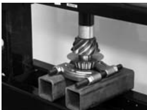
Фото 6. Установка маслоотражателя и ко- нуса подшипника внутренней шестерни.
