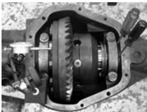
Фото 1. Подсчет начальной толщины прокладок.
