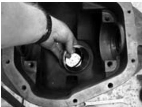
Фото 7. Установка прокладок и крышки подшипника ведущей шестерни.
