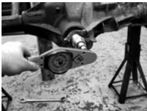
Фото 14. Измерение предварительного на- тяга подшипника веду- щей шестерни.
