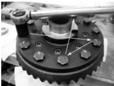
Фото 5. Установка кольцевого зубчатого колеса на держатель.
