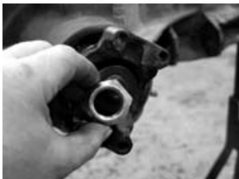
Фото 13. Установка хо- мута, кольцевой прок- ладки и гайки веду- щей шестерни.
