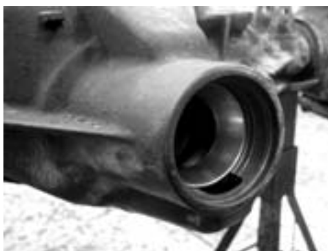
Фото 8. Установленная крышка внешнего подшипника ведущей шестерни.
