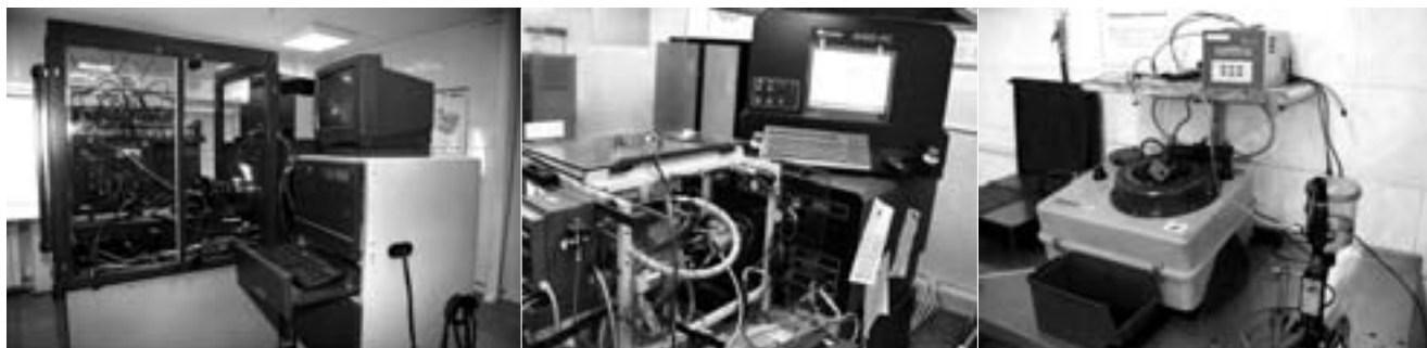
Оснащение участка ремонта и регулировки дизельной топливной аппаратуры
