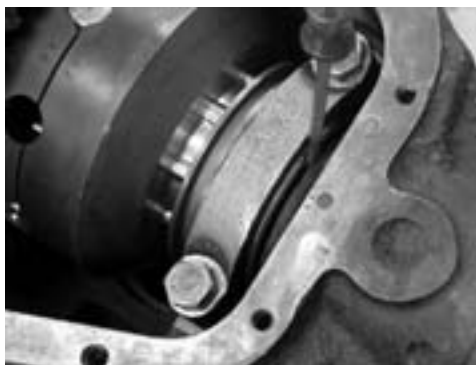
Фото 2. Подъем основания к стороне расположения кольцевого зубчатого колеса.
