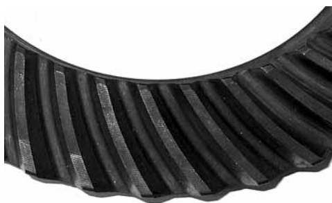
Фото 7. Зубья кольцевого зубчатого колеса с обратной спиралью.
