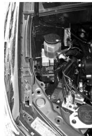
Фото 7. На место штатного вставлено реле, в котором нет нормально замкнутого контакта.
