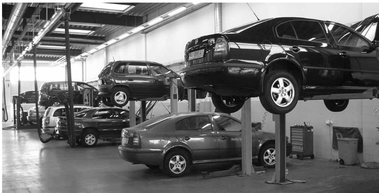
Фото 3. Стандартные рабочие места располагаются в одном помещении зоны обслуживания и ремонта.
