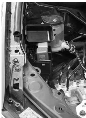
Фото 5. Установка «нового» реле No.3 позволила отключить функцию DRL RX 350.
