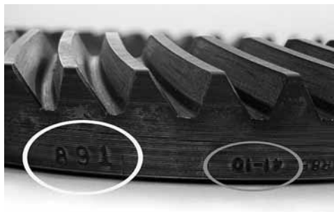
Фото 8. Номер зубчатой пары кольцевого зубчатого колеса и количество зубцов.
